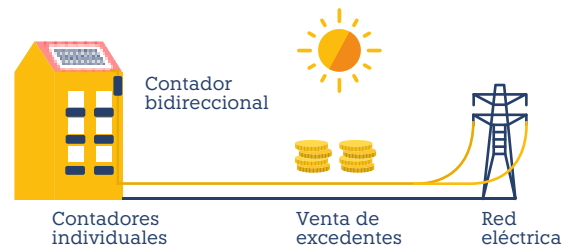
Figura 8. Autoconsumo colectivo con excedentes no acogido a compensación.
