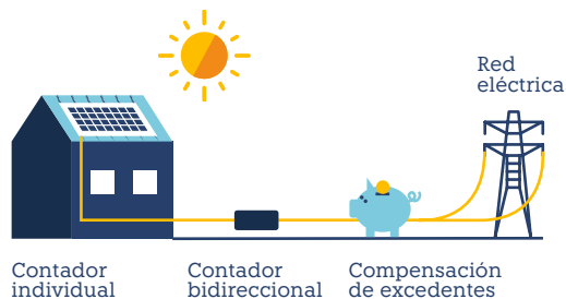
Figura 5. Autoconsumo individual con excedentes acogido a compensación.
