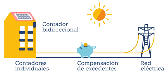
Figura 6. Autoconsumo colectivo con excedentes acogido a compensación
