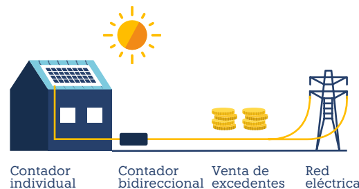
Figura 7. Autoconsumo individual con excedentes no acogido a compensación.
